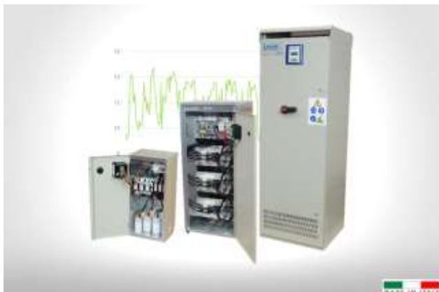
Les appareils de la série **GE 230V** sont adaptées aux réseaux triphasés 230V **peu pollué** en courant harmonique. Ces appareils garantissent une correction précise du facteur de puissance, grâce à une logique à plusieurs étapes qui fractionne efficacement la puissance.
