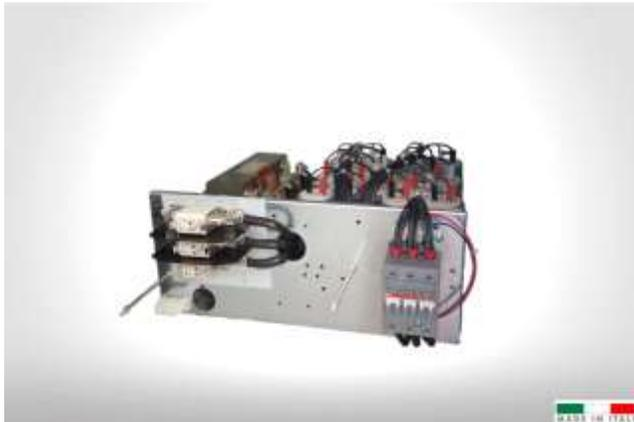
Les tiroirs de la série **RCL** sont conçus pour nos armoires de type **G9E**. A l'intérieur de chaque tiroir sont assemblées des triades de condensateurs monophasés. Les versions présentées dans le catalogue sont toutes équipées de self de bloc, pour les applications dans des réseaux très pollués.
