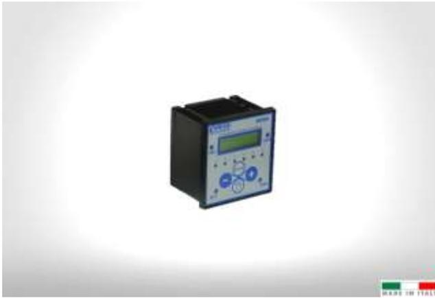
La série **BMR 6** de régulateurs var métriques à microprocesseur est conçue pour le contrôle précis des grandeurs électriques des batteries de condensateurs, telles que la tension, le courant, le facteur de puissance, le taux de distorsion harmonique du courant, ainsi que la température ambiante et les différentes puissances.
