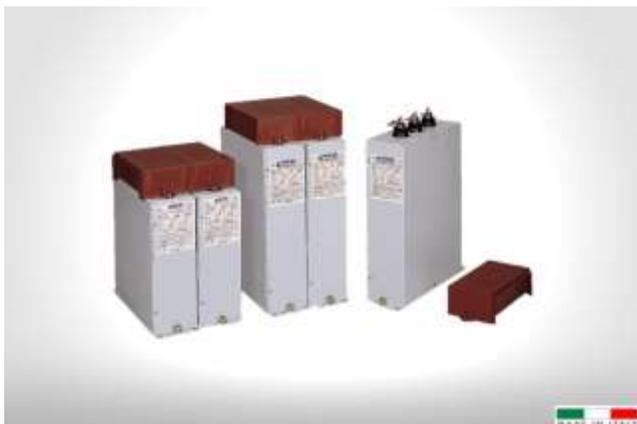
Les condensateurs modulaires triphasés de la série **CT** sont conçus pour la compensation du facteur de puissance fixe à basse tension. Les condensateurs sont construits de manière à assurer une dissipation thermique optimale. Trois unités MKAS monophasées sont assemblées à l'intérieur, chacune étant équipée d'un dispositif anti-explosion.
