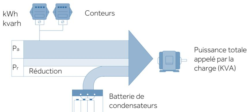
La plupart des charges, dans les systèmes de distribution électrique actuels, sont inductives et nécessitent deux types de puissance:
