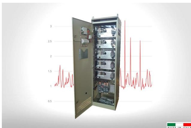
Les batteries de condensateurs de la série **AAR/100** conviennent aux réseaux triphasés avec une **haute distorsion harmonique** en courant. Ces équipements garantissent une compensation précise, grâce à une logique multi-étape qui fractionne efficacement la puissance. Par ailleurs sur les armoires type G6E et G8E, tous les composants des gradins sont montés sur des tiroirs, facilement extractible se situant à l'avant de l'armoire, pour une gestion et une maintenance simplifiées.
