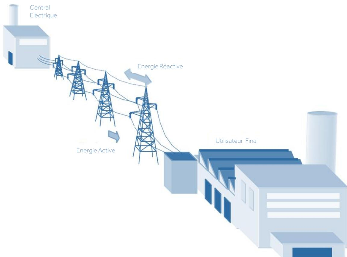
Le facteur de puissance maximal possible est 1,00, ce qui signifie que 100% de la puissance fournie à la charge est la puissance active convertie en énergie utile. Toute valeur inférieure à 1,00 indique que le système d'alimentation hors charge doit être surdimensionné.
