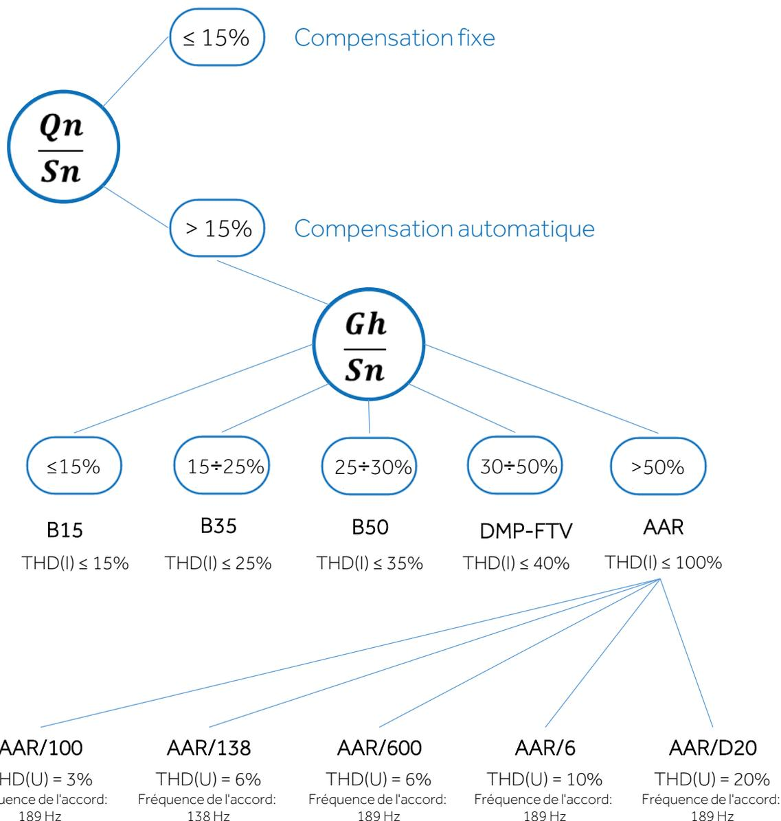
**$S_n$**  = Puissance apparente du transformateur (kVA)
