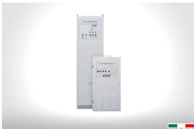
La série **FA05** est conçue pour réduire la pollution des courants harmoniques engendrée par des onduleurs, des charges polluantes industrielles, etc. Le filtre passif est basé sur un circuit résonnant série entre une batterie de condensateurs et des réactances triphasés. De cette manière les courants harmoniques accordés à la fréquence de résonance trouvent une impédance très faible dans le filtre et préfèrent y entrer en lieu de manière circulaire dans le réseau de l'installation.
