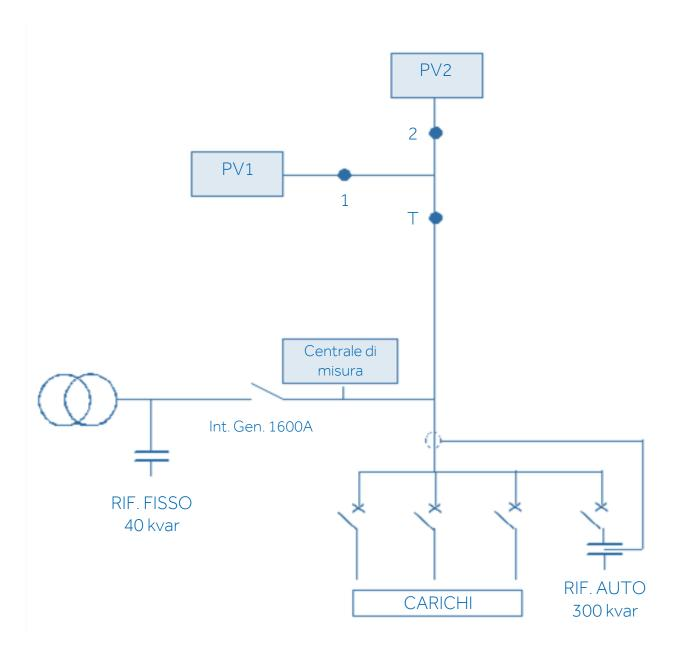
In questo caso il banco di condensatori è un  $\underline{AAR/600}$ , da 300kvar con gradini da 25+50+3X75 kvar, per THD(I)max. = 100% e THD(U)max. = 6% in rete.
