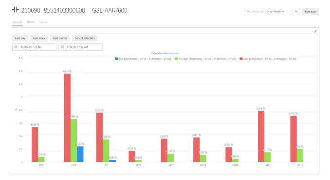
Di seguito si mostra lo **Spettro armonico in corrente** quando il fotovoltaico genera la quasi totalità della corrente assorbita dal carico:
