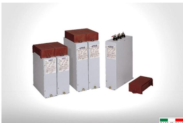
I condensatori modulari trifase della serie **CT**, disponibili in tre tipologie, sono progettati per il rifasamento in bassa tensione. La costruzione dei condensatori è realizzata per garantire un'ottima dissipazione termica. All'interno sono assemblate tre unità monofase, ciascuna dotata di dispositivo antiscooppio.
