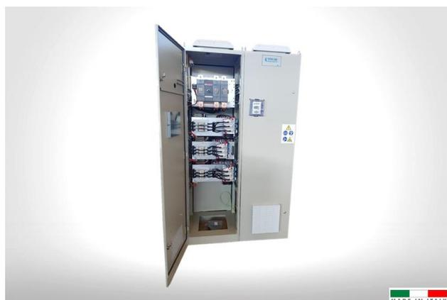
La série **B35-ST** est exempte de transitoires de commutation grâce à la technologie «croisée par zéro», et a été conçu pour améliorer les performances des équipements traditionnels tels que: l'augmentation de la durée de vie de la batterie de condensateurs, la diminution du temps de réponse de l'appareil suivre la fluctuation rapide des charges avec un **contenu harmonique moyen-bas**.
