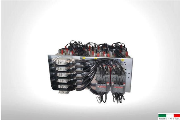
Les châssis **RCM** peuvent être installés uniquement sur les armoires COMAR type **G6E** et **G8E**. À l'intérieur de chaque tiroir il y a des condensateurs monophasés couplés en triangle. En cas de distorsion harmonique élevée sont disponibles les versions avec selfs de bloc anti-harmoniques (série AAR/...).
