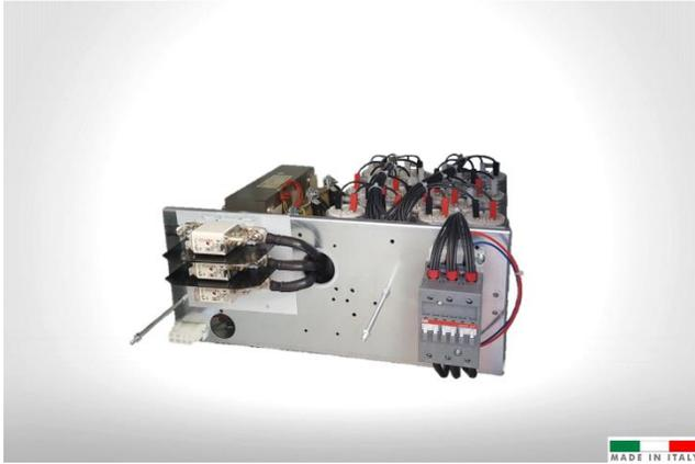
Les châssis **RCL** peuvent être installés uniquement sur les armoires COMAR type **G9E**. À l'intérieur de chaque tiroir il y a des condensateurs monophasés couplés en triangle. Les versions présentées dans le catalogue sont toutes équipées de selfs de bloc anti-harmoniques, pour les applications avec une taux de distorsion harmonique en courant élevée.
