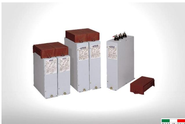
Les condensateurs **CT** sont de **type modulaires**, disponibles en trois versions, conçus par rapport à la pollution harmonique. Ils sont conçus pour la compensation fixe à Basse tension. La construction des condensateurs est faite pour assurer une excellente dissipation thermique. À l'intérieur, il y a trois unités monophasées, chacune avec système de sécurité à surpression.
