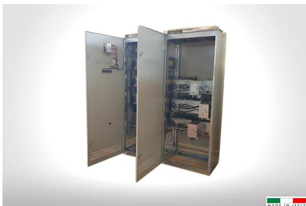
L'intera serie **AAR/100-ST** è priva di transistori di commutazione grazie alla tecnologia «zero-crossing», ed è stata realizzata per migliorare le prestazioni delle apparecchiature tradizionali, quali: l'aumento della durata della batteria di condensatori, la diminuzione del tempo di risposta dell'apparecchiatura per seguire rapide variazioni dei carichi. Indicata per applicazioni con **alto contenuto armonico** quali automotive, stabilimenti portuali, officine meccaniche, ...
