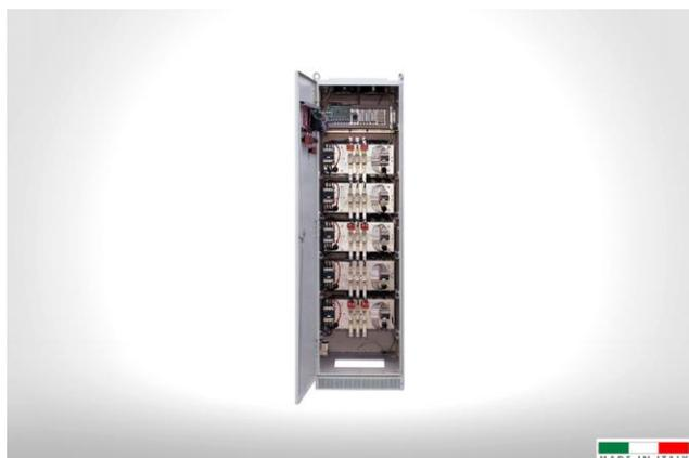
Il **FAM05/07** passivo è realizzato accordando opportunamente in frequenza, una batteria di condensatori ed una reattanza trifase. In questo modo è realizzato un circuito risonante che è scelto come via preferenziale dalla corrente armonica che si vuole ridurre, ed è dotato di **sistema di controllo a microprocessore per l'inserimento di moduli**. Caratteristiche:
