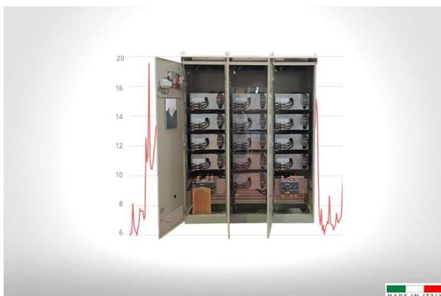
I rifasatori della serie **AAR/D20** sono la soluzione ideale in presenza di reti trifase con **altissimo contenuto armonico sia in corrente sia in tensione**. L'efficacia del rifasamento è garantita da una logica multi gradino che ne fraziona efficacemente la potenza. Inoltre, sui quadri di tipo G6E e G9E, tutti i componenti delle batterie sono assemblati su cassette, facilmente estraibili dal fronte del quadro, per una semplice gestione e manutenzione.
