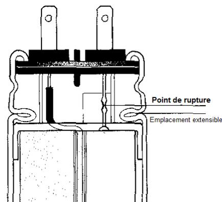
La présence d'**huile isolante**, de type végétal, empêche immédiatement la formation d'arcs électriques à l'intérieur du point de rupture des fils.
