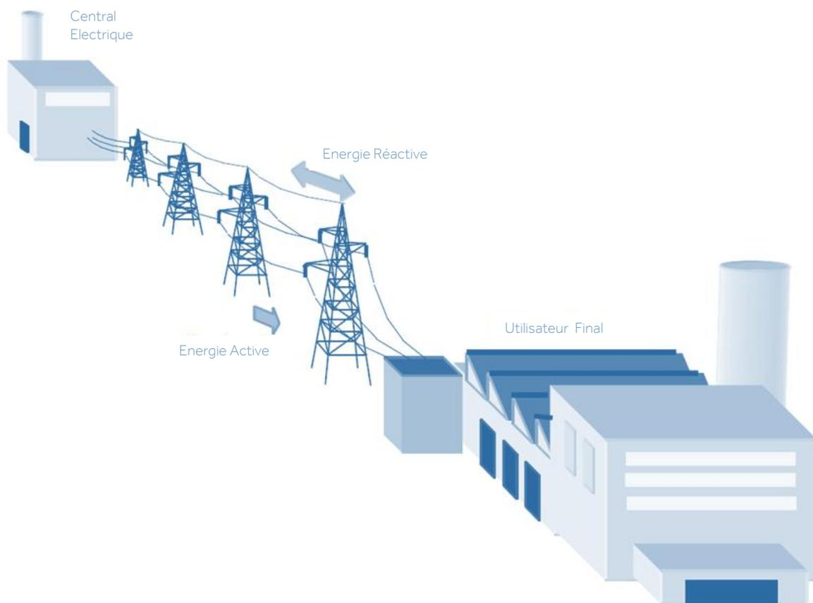
Le facteur de puissance maximal possible est 1,00, ce qui signifie que 100% de la puissance fournie à la charge est la puissance active convertie en énergie utile. Toute valeur inférieure à 1,00 indique que le système d'alimentation en charge doit être surdimensionné.
