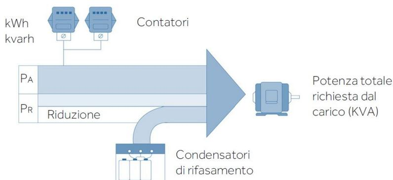
Più alto è il fattore di potenza, più efficace è l'uso delle apparecchiature elettriche, ad es. un FP di 0,7 significa che il 70 per cento dell'energia fornita all'apparecchiatura viene utilizzata in modo efficace e il 30% viene sprecato. **Questo spreco è un costo inutile!**
