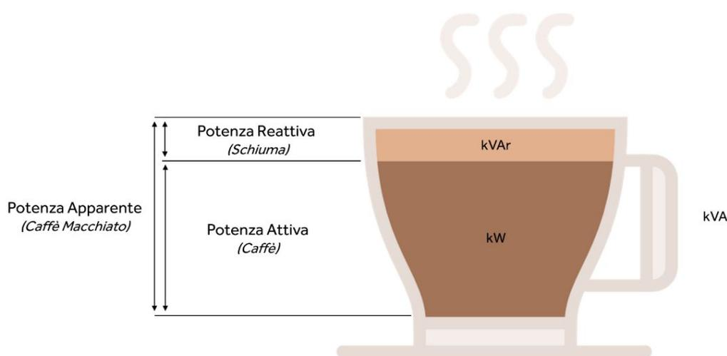
Il **Rifasamento** è la tecnica volta a migliorare il **Fattore di Potenza** ( $\cos\phi$ ) delle macchine elettriche in presenza di carichi induttivi, che quindi necessitano di un campo elettromagnetico per poter funzionare.
