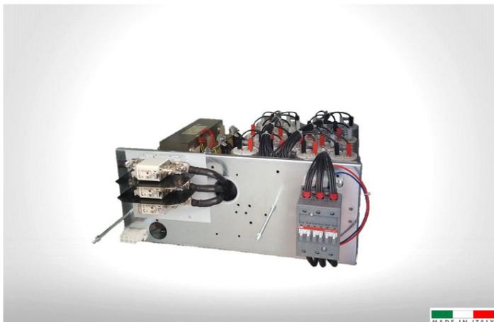
I cassetti della serie **RCL** sono progettati per i nostri armadi tipo **G9E**. All'interno di ciascun cassetto sono assemblate terne di condensatori monofase. Le versioni riportate a catalogo sono tutte dotate di induttanze di blocco, per applicazioni in presenza di un alto livello di distorsione armonica in corrente.
