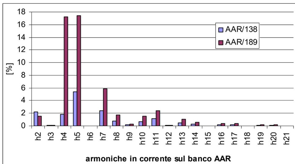
Si può notare che le armoniche che fluiscono sul condensatore sono complessivamente inferiori:
