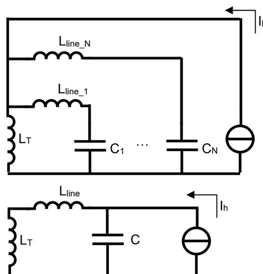
Nella pratica si possono considerare nei calcoli maggiorazioni dell'impedenza equivalente del trasformatore tali da inglobare il contributo delle linee di collegamento tra apparecchiature di rifasamento ed il trasformatore a monte. In pratica si ricava che l'inserimento del cavo in serie all'apparecchiatura distribuita fa abbassare i valori di potenza reattiva a cui si potrebbe verificare la risonanza.
