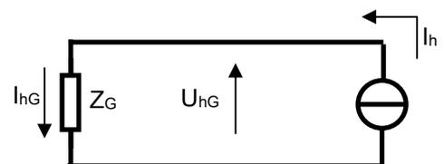
Se consideriamo il circuito equivalente di una rete con carichi distortanti, come quello indicato in figura, dove  $Z_G$  è l'impedenza equivalente della rete senza i carichi distortanti, le correnti armoniche prodotte ( $I_h \equiv I_{hG}$ ) generano delle tensioni armoniche  $U_{hG}$ , facilmente misurabili in ogni punto della rete.
