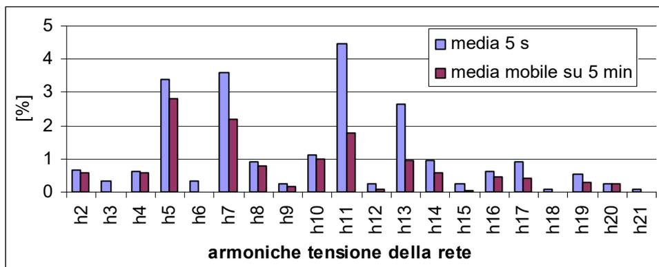
In conclusione, considerando i valori di picco delle armoniche si rischia di sovra dimensionare il quadro.
