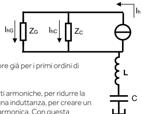
L'impedenza del condensatore diventa sempre più bassa, più l'ordine dell'armonica aumenta, in pratica diventa inferiore a quella del trasformatore già per i primi ordini di armoniche più comuni prodotti dai carichi distortanti.
