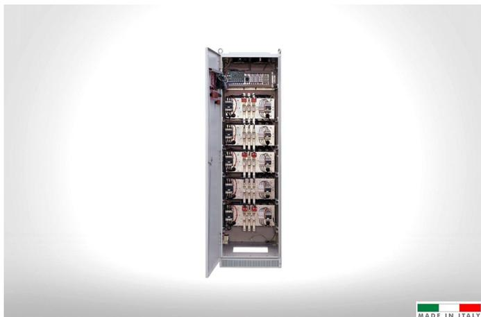
Il **FAM05** passivo è realizzato accordando opportunamente in frequenza, una batteria di condensatori ed una reattanza trifase. In questo modo è realizzato un circuito risonante che è scelto come via preferenziale dalla corrente armonica che si vuole ridurre, ed è dotato di **sistema di controllo a microprocessore per l'inserimento di moduli**. Caratteristiche:
