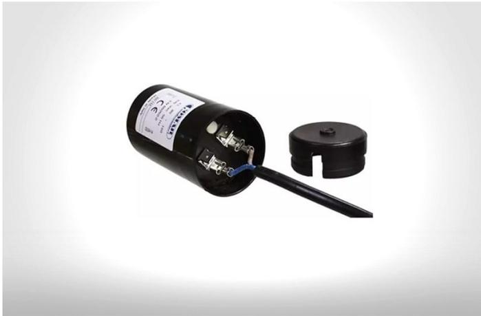
Il condensatore elettrolitico **EL** ha un'**alta capacità** ( $\mu\text{F}$ ) in grado di fornire un'elevata coppia di avviamento al motore. È un condensatore non polarizzato, progettato per applicazioni a tensione alternata intermittente per motori monofase.
