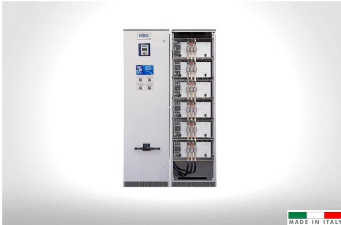
I rifasatori della serie **AAR/100** sono particolarmente indicati per reti trifase con **alto contenuto armonico** in corrente. Queste apparecchiature garantiscono un accurato rifasamento, grazie ad una logica multi gradino che ne fraziona efficacemente la potenza. Inoltre, sui quadri di tipo G6E, G8E e G9E, tutti i componenti delle batterie sono assemblati su cassette, facilmente estraibili dal fronte del quadro, per una semplice gestione e manutenzione.
