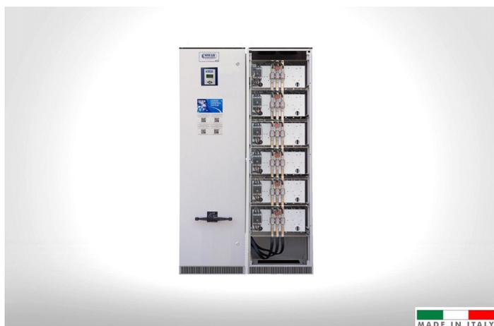
I rifasatori della serie **AAR/138** sono particolarmente indicati per reti trifase con **alto contenuto armonico** in corrente con presenza di **armoniche di 3° grado**. Queste apparecchiature garantiscono un accurato rifasamento, grazie ad una logica multi gradino che ne fraziona efficacemente la potenza. Inoltre, sui quadri di tipo G6E e G9E, tutti i componenti delle batterie sono assemblati su cassette, facilmente estraibili dal fronte del quadro, per una semplice gestione e manutenzione.
